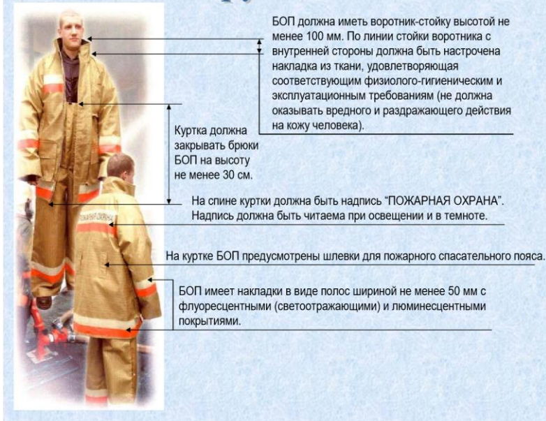
Рис.46 Конструкция БОП
