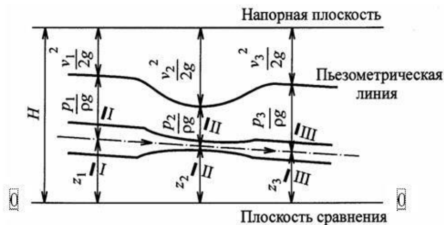
Рисунок 3 - Иллюстрация уравнения Бернулли
