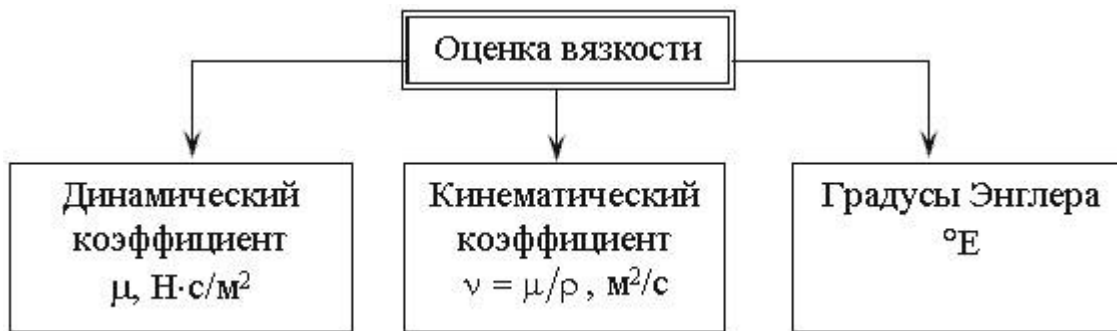
Рис. 1.8. Способы оценки вязкости жидкости
