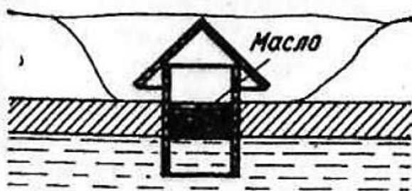
Утепление проруби при вмораживании трубы
