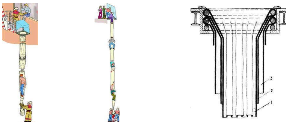
Рис.8. Спасательный рукав.1- внутренний рукав; 2- эластичный рукав; 3- теплоотражательная оболочка
