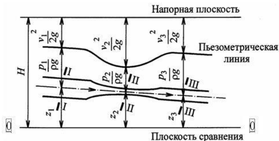
Рисунок 3 - Иллюстрация уравнения Бернулли
