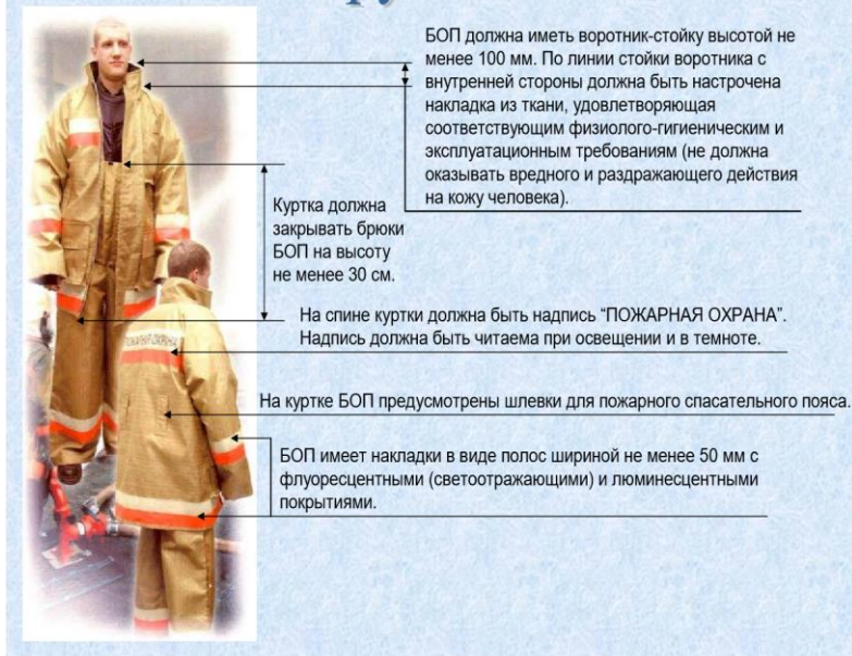
Рис.46 Конструкция БОП
