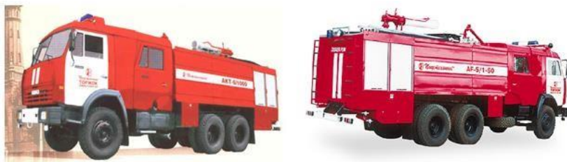
Рис. 84 Автомобили комбинированного тушения: слева - АКТ 6/1000-80/20(53229)ПМ-570, справа – АФ-5/1-60
