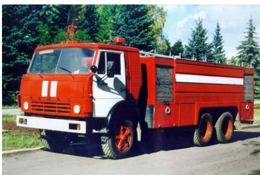
Рис.77 Пожарный автомобиль пенного тушения АВ-20(53213)ПМ-525
