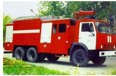
Рис.72 Пожарная автоцистерна АЦ-7-40(53213)ПМ-524
