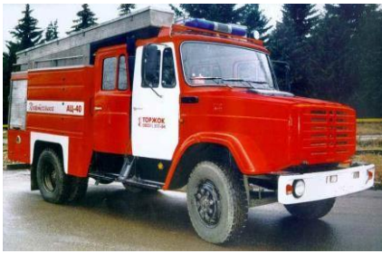
Рис.67 Пожарная автоцистерна АЦ-2,5-40 (433362) ПМ-540
