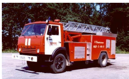
Рис.86 Пожарная автоцистерна с лестницей АЦЛ-3-40-17(4925) ПМ-537
