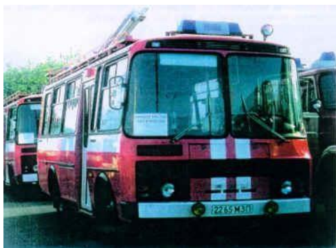
Рис.95 Пожарный автомобиль связи и освещения АСО-20(3205)
