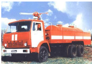
Рис.78 Пожарный автомобиль порошкового тушения АП-5(53213)196
