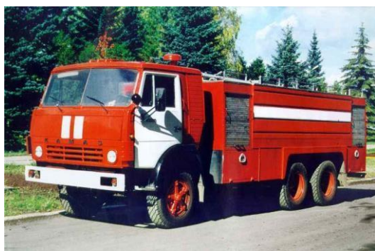
Рис.77 Пожарный автомобиль пенного тушения АВ-20(53213)ПМ-525
