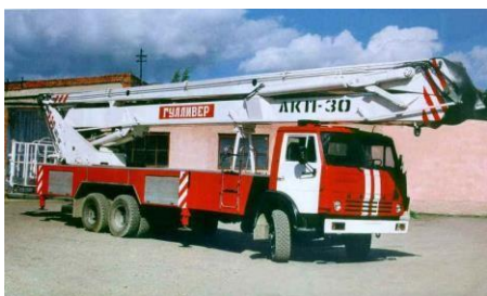
Рис.91 Пожарный коленчатый автоподъемник АКП-30(53213)ПМ-509Б
