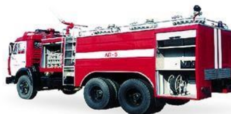
Рис. 79 Автомобиль порошкового тушения АП-5000-50(53215)ПМ-567А
