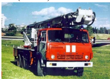
Рис.92 Пожарный коленчатый автоподъемник АКП-35(53213)ПМ545А
