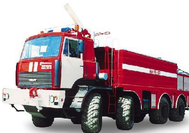
Рис.70. Пожарный аэродромный автомобиль АА-15/80-100/3 (790912) ПМ-539
