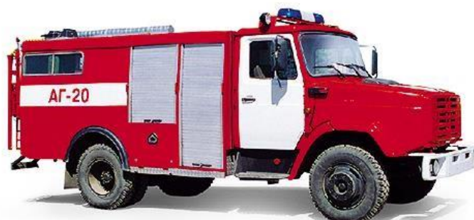
Рис.94. Пожарный автомобиль газодымозащитной службы АГ-20(433362)ПМ-585
