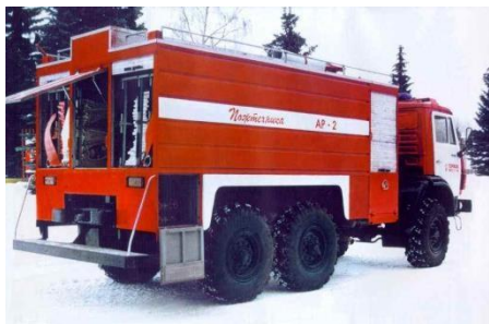
Рис. 96 Пожарный рукавный автомобиль АР-2(43101)ПМ-538
