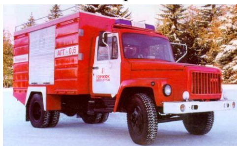
Рис.83 Пожарный автомобиль газового тушения АГТ-0,6(3307)ПМ-547
