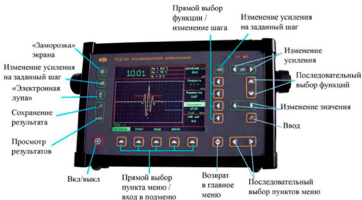
Рис. 7.4. Ультразвуковой дефектоскоп УСД-60
