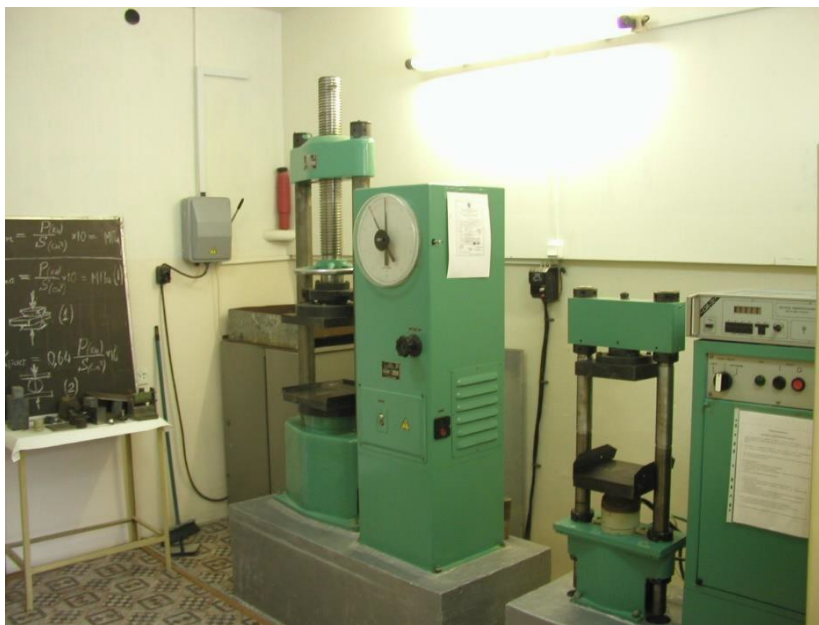
Рис. 1 Прессы в лаборатории физико-механических свойств горных пород
