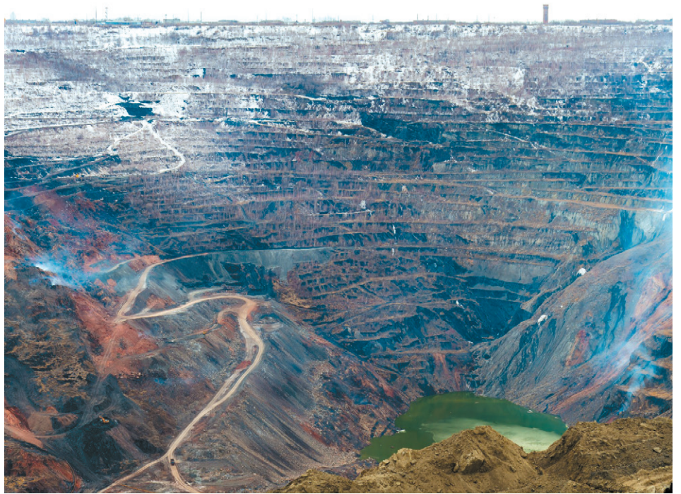
Длина Коркинского разреза – 3,1 км, ширина – 2,6 км, глубина – 493 м. Объем выработанного пространства – 1,3 млрд куб. м.
