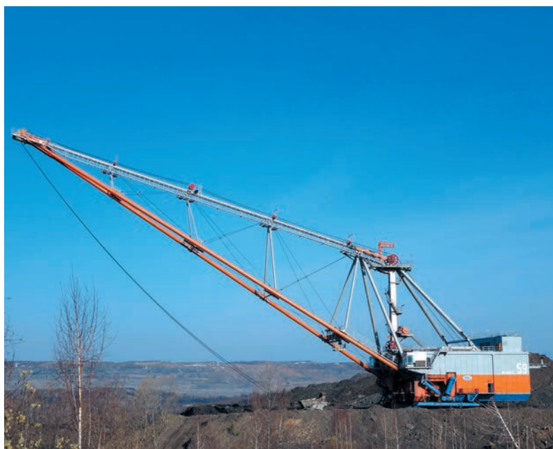
Рис. 2. Экскаватор шагающий или драглайн ЭШ 20.90С производства Уралмашзавода
