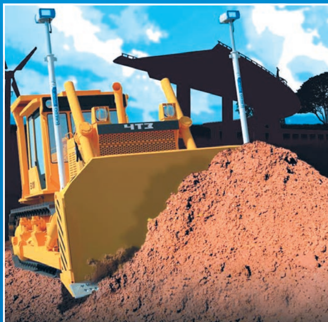
«КРЕДО» на марше. Оснащенный лазерным сканером бульдозер применяется для создания цифровой модели местности
